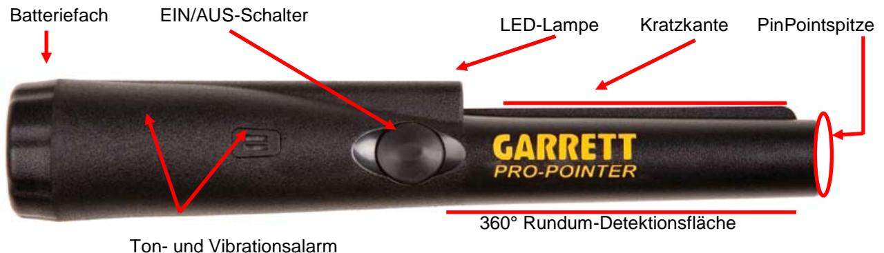
Der **PRO-POINTER** ist ein vollautomatischer Handmetalldetektor, entwickelt für eine präzise Punktortung von Metallobjekten als Ergänzungsgerät zu Ihrem Hobby-Metallsuchgerät. Den PRO-POINTER können Sie auch zur Suche von Objekten wie Metalle, Leitungen oder Kabel in Wänden benutzen.
